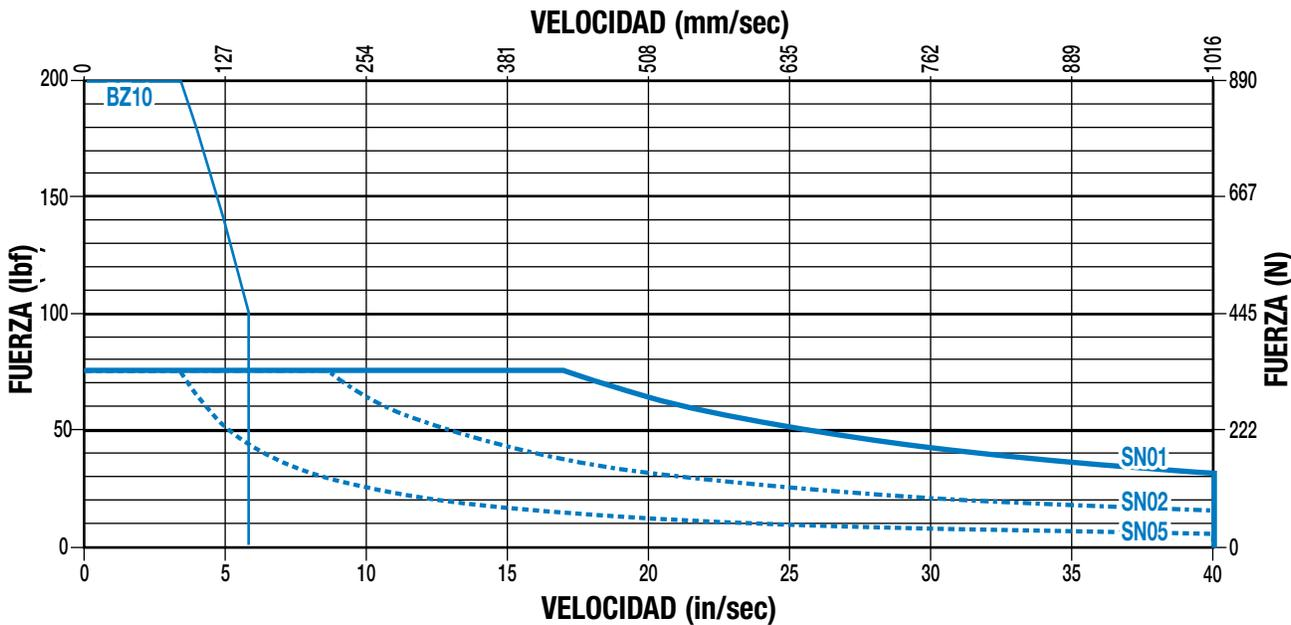
**LÍMITES DEL PV:** Cualquier material que soporte una carga deslizante está limitado por la acumulación de calor. Los factores que afectan a la tasa de generación de calor en una aplicación son la presión sobre la tuerca en libras por pulgada cuadrada (P) y la velocidad de la superficie en pies por minuto (V). El producto de estos factores proporciona una medida de la severidad de una aplicación.
