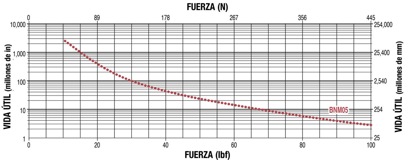
**NOTA:** La vida útil prevista  $L_{10}$  de un actuador lineal de tornillo de bolas se expresa como la distancia de recorrido lineal que se espera que el 90% de los tornillos de bolas fabricados, con un mantenimiento adecuado, alcancen o superen. Esto no es una garantía y este gráfico debe utilizarse únicamente con fines estimativos.
