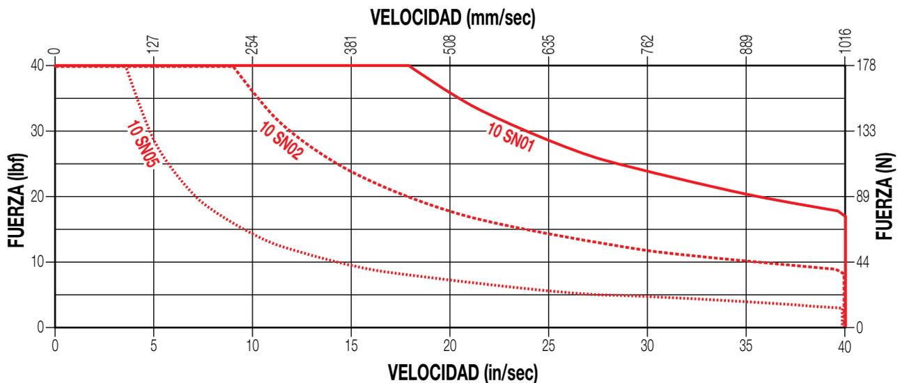
**LÍMITES PV:** Cualquier material que soporte una carga deslizante está limitado por la acumulación de calor. Los factores que afectan a la tasa de generación de calor en una aplicación son la presión sobre la tuerca en libras por pulgada cuadrada (P) y la velocidad de la superficie en pies por minuto (V). El producto de estos factores proporciona una medida de la severidad de una aplicación.
