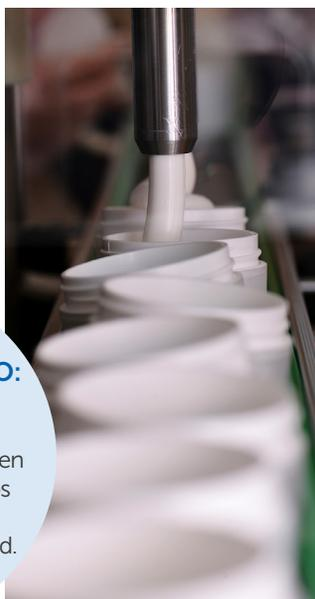
Además de ser eficientes, las máquinas utilizadas para procesar alimentos deben mantener la seguridad de los mismos al no albergar ni introducir bacterias, fluidos lubricantes u otros contaminantes que puedan perjudicar a los consumidores. Como parte de las máquinas de producción de alimentos y bebidas, los actuadores eléctricos deben estar fabricados con materiales resistentes a la corrosión y que no filtren sustancias tóxicas a los productos alimenticios o a los
