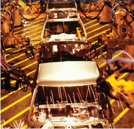
Widerstandspunktschweißen, Verbinden, Einpressen, Nieten, Stanzen, Mutternplatzierung
