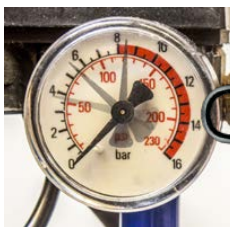
Erhöhter Luftdruck zur Kompensation niedriger Schweißkraft
