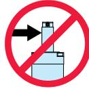
Привод GSWA со встроенным электродвигателем не предназначен для использования при воздействии боковых нагрузок на шток. Подвижные грузы должны передвигаться по направляющим опорным конструкциям. Направление действия сил и нагрузок должно совпадать с осевой линией перемещения штока. Наличие боковых нагрузок сокращает срок службы привода.
