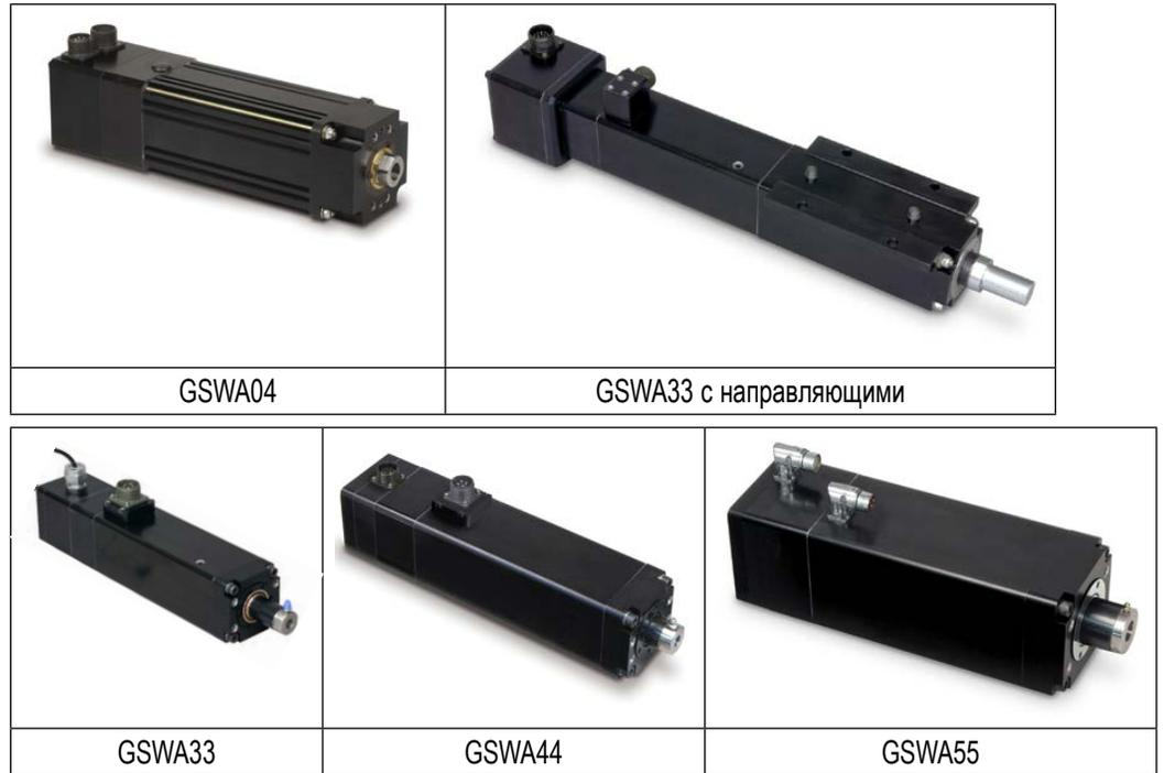
Привод сварочных клещей GSWA (рис. 1.2) представляет собой компактный привод с винтовой передачей и высоким тяговым усилием, используемый в сервосистемах управления точечной сваркой. Привод обеспечивает линейное перемещение подвижного электрода сварочных клещей и заданное усилие (сжатие) для точечной сварки.
