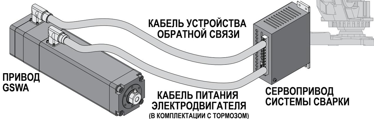
Рис. 2.1.1: Типичное соединение привода GSWA в варианте комплектации с тормозом и сервопривода однокоординатной системы управления точечной сваркой
