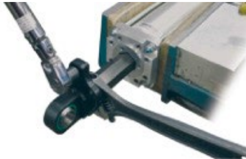
图 4.4: (图为 SWA) 对于六角杆, 在将附件、连杆或负载连接到电动缸上时, 用一把扳手在杆的平面上固定住推力杆。使用扭矩扳手将连接杆的一端拧紧到执行机构的螺纹连接点上。表 4.2 中提供的扭矩值。
