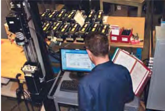
В ходе функциональных испытаний в течение 350 циклов регистрируются длина хода, величина крутящего момента без нагрузки, стандартное отклонение усилия как функция силы тока на входе.
