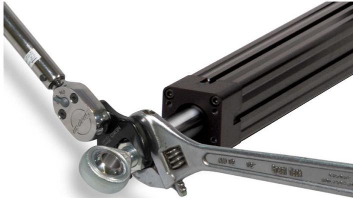
Abbildung 4.3: Bei RSA halten Sie die Schubstange mit einem Schraubenschlüssel an den Abflachungen am Ende der Schubstange fest, wenn Sie Zubehör, Gestänge oder Last am Antrieb befestigen.
