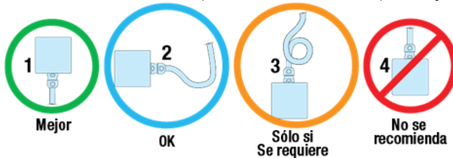
Figura 5.1: Trazado recomendado del cableado de ServoWeld.
