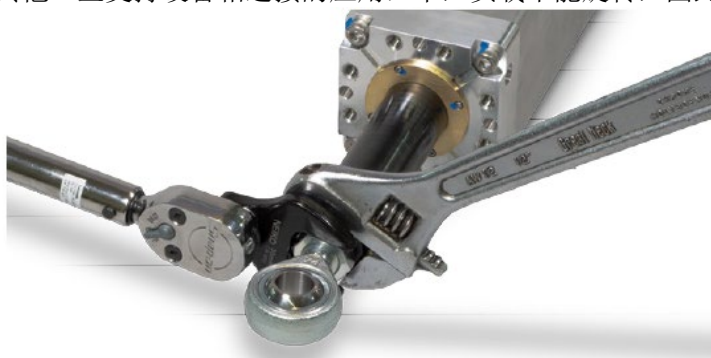
图 4.3: 对于圆形推力杆，当把附件、联动装置或负载安装到电动缸上时，用扳手在推力杆端部平面上固定住推力杆。用扭力扳手将连接杆端头拧紧到电动缸的螺纹连接点。扭矩值见表 2.2。
