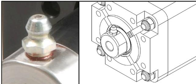
*Abbildung 7.1: Ein Standard-Schmierzapfen ermöglicht das periodische Nachschmieren von ServoWeld-Antrieben. Dies kann in der Regel innerhalb von 5 Minuten durchgeführt werden, ohne den Antrieb aus seiner Installation zu entfernen.*
