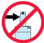
Bei einigen Schweißzangenkonstruktionen kann es zu einer übermäßigen Seitenbelastung des Stellantriebs kommen, die die Gesamtlebensdauer verringert. Insbesondere bei "C"-Zangen Konstruktionen sind Maßnahmen erforderlich, um die Einwirkung von Seitenkräften zu begrenzen. Zur Optimierung der Lebensdauer empfiehlt Tolomatic eine geringere Seitenbelastung als in Abbildung 4.2 angegeben.
