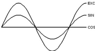
Bild 5.6: Motor-Drehlage bei 90
