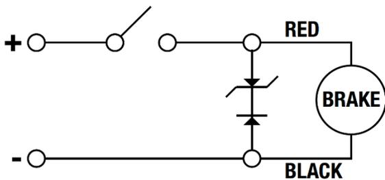
Abbildung 6.3: Erhöhte Ein- / Auskuppelzeit, bester Schutz
