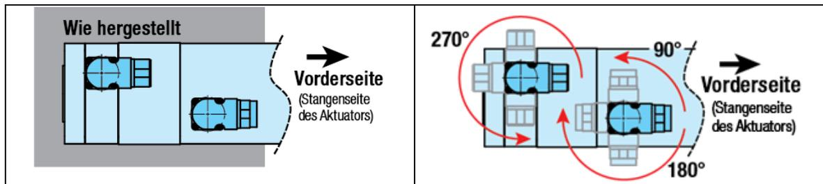
Abbildung 5.2: Steckerdrehung. Beachten Sie, dass die Tolomatic-Standardstecker von  $-90^\circ$  bis  $+180^\circ$  gedreht werden können, so dass die Kabel zur Vorderseite (Stangenseite, wie hergestellt), zu einer Seite, zu beiden Seiten oder zur Rückseite des Antriebs angeschlossen werden können.
