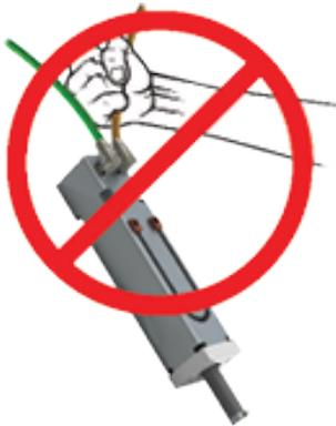
Das Gewicht des CSW(X) ServoWeld™-Antriebs liegt bei ca. 10,2 bis 15,6 kg (22,6 bis 34,5 lb). Beim Anheben dieses Geräts ist besondere Vorsicht geboten. Tragen Sie das Gerät nicht an den Anschlüssen. Die Anschlüsse sind nicht für das Gewicht des Antriebs ausgelegt.
