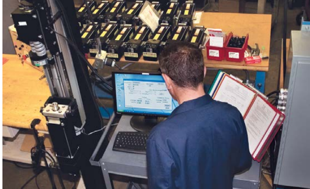
Prueba de funcionamiento de la unidad durante cientos de ciclos, cuantifica las carreras, la longitud, par bajo carga nula, entrada de corriente frente a la desviación de fuerza estándar.
