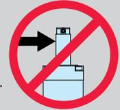
Zur Begrenzung der Seitenkräfte sind entsprechende Maßnahmen zu treffen, insbesondere bei C-förmigen Auslegungen. Zur Optimierung empfiehlt Tolomatic Seitenkräfte von weniger als 5 % der axialen Kräfte (Kraftabgabe der Schubstange) bei allen Rollengewindekonfigurationen.
