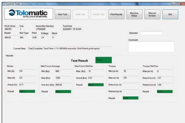
Laufende Ergebnisse für Testparameter während der Funktionsprüfung.
