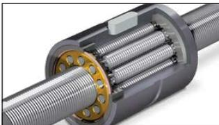
Bei normalen Rollengewinden wird vor dem Präzisionsschliff eine Einsatzhärtung (Oberfläche) vorgenommen, was zu einer deutlich größeren Einsatzhärtungstiefe und einer sehr viel höheren DLR führt. Die tiefere Oberflächenhärte und höhere DLR verleihen dieser Bauweise einen großen Vorteil bei der Lebensdauer (und der Behandlung mit Schmiermitteln) im Vergleich zur umgekehrten Bauweise.
