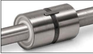
Planeten Rollengewinde können Schwerlasten bewältigen, denn sie enthalten präzisionsgeschliffene Rollen, die in ein präzisionsgeschliffenes Gewinde und eine präzisionsgeschliffene Mutter einrasten. Im Vergleich zu einem Kugelgewinde derselben Größe und Steigung sind die Bauteile des Rollengewindes feingängiger, so dass mehr Kontaktpunkte und ein größerer Kontaktradius entstehen. Das führt zu einer geringeren Belastung pro Kontaktpunkt.
