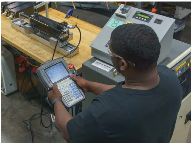
Die abschließende Systemprüfung stellt sicher, dass die Feedback-Einrichtung genau an die Pole des ServoWeld-Motors angepasst ist.
