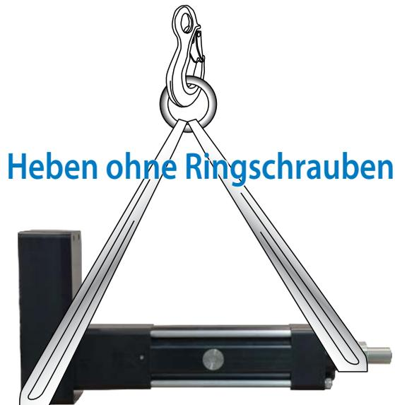
Abbildung 4-2 RSX richtig heben ohne Ringschrauben
