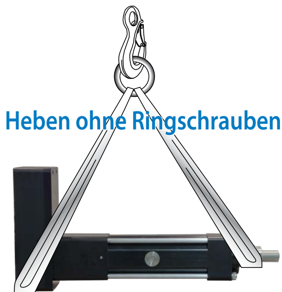
Abbildung 4-2 RSX richtig heben ohne Ringschrauben
